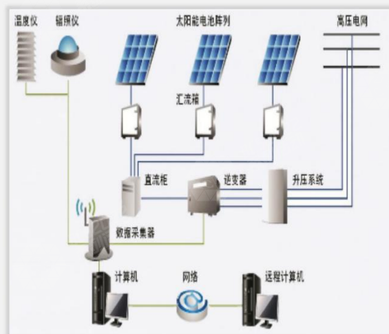
模拟仿真光伏发电工艺流程
